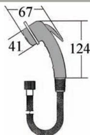
Душ встраиваемый многофункциональный. Распылитель вытягивается на требуемую длину, после использования убирается в коробку. Изготовлен из белого АБС-пластика, фитинги - из нерж. стали. Шланг - длина 1,8м. В комплект входит: распылитель, коробка душа. Производитель Ultraflex (Италия).
