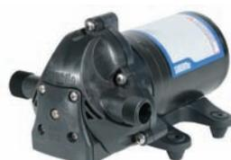
Насос водяной «Aqua King» предназначен для работы в судовых системах пресной воды. Характеристики: трехкамерная конструкция, автоматическое включение, самовсасывание (до 2,4м в.ст.), встроенный невозвратный клапан, резьбовой патрубков, возможность работы "всухую". Защита
