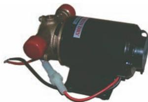
Насос водяной самовсасывающий общего назначения. Может использоваться при подаче воды в системе водоснабжения, а также в качестве насоса осушительного. Рабочий элемент – импеллер **06211**. Производительность - 5 л при подаче воды на высоту 4 м. Напряжение – 12
