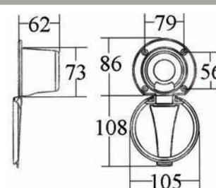
Коробка для скрытого монтажа распылителя душа. Изготовлена из белого АБС-пластика. В комплект входит крепеж из нерж. стали. Производитель Ultraflex (Италия).
