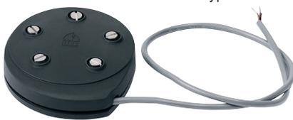
Датчик уровня жидкости ультразвуковой, предназначен для измерения уровня топлива (бензин или дизельное топливо), пресной воды и любых видов бытовых сточных вод. Датчик устанавливается на внешнюю горизонтальную плоскость резервуара над самой
