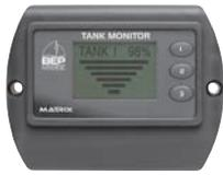
Монитор контроля состояния баков Contour Matrix способен контролировать до 3-х баков с техническими жидкостями. Совместим с датчиками уровня на напряжение 0-5 V. Для датчиков VDO (10-180 Ом) или ULTRAFLEX (33-240 Ом) необходимо использовать адаптер 600-TLM-SIF.
