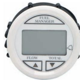
Поставляется в комплекте с датчиком расхода топлива. Диапазон измерения: 2,5-160 л/час. Расходомер имеет функцию замера общего расхода топлива и расхода топлива в текущий момент времени. Предусмотрена звуковая сигнализация при отклонении расхода топлива от установленной величины. Расходомер может показывать значения расхода топлива в галлонах США, в галлонах Великобритании или в литрах. Цвет белый. Производитель Ultraflex (Италия).
