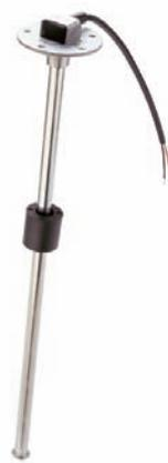
Датчики указателя уровня топлива индукционные. Изготовлены из нержавеющей стали. Для каждого бака датчик подбирается индивидуально по высоте. Для баков различной высоты подбирается соответствующий датчик. Датчики совместимы с указателями уровня топлива Faria/Ultraflex. Производитель Wema-system (Норвегия).
