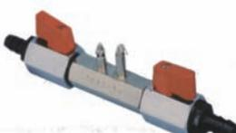
Адаптер для подключения к топливной системе двух баков, с коммутирующими кранами и переходником. Подходит к подвесным моторам Yamaha, Mariner, Mercury, Honda. Производитель Nuova Rade (Италия).
