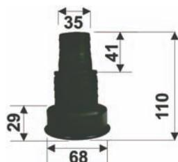
Патрубок топливный заливной для баков стационарных  $\varnothing$  35 мм – 51 мм. Изготовлен из пластмассы черного цвета. Производитель CEREDI (Италия).
